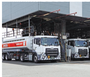
タンクローリーの充填出荷
